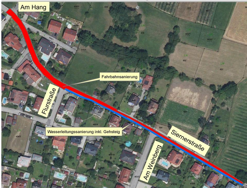
Ab 16. August werden in der Siernerstraße Sanierungsmaßnahmen durchgeführt. Im ersten Bauabschnitt wird die Wasserleitung zwischen Hausnummer 31 (beim Maulbeerbaum) und Kreuzung Flurstraße neu verlegt. Die Maßnahme wird im Bereich des Gehsteigs durchgeführt, der im Anschluss wiederhergestellt wird.
